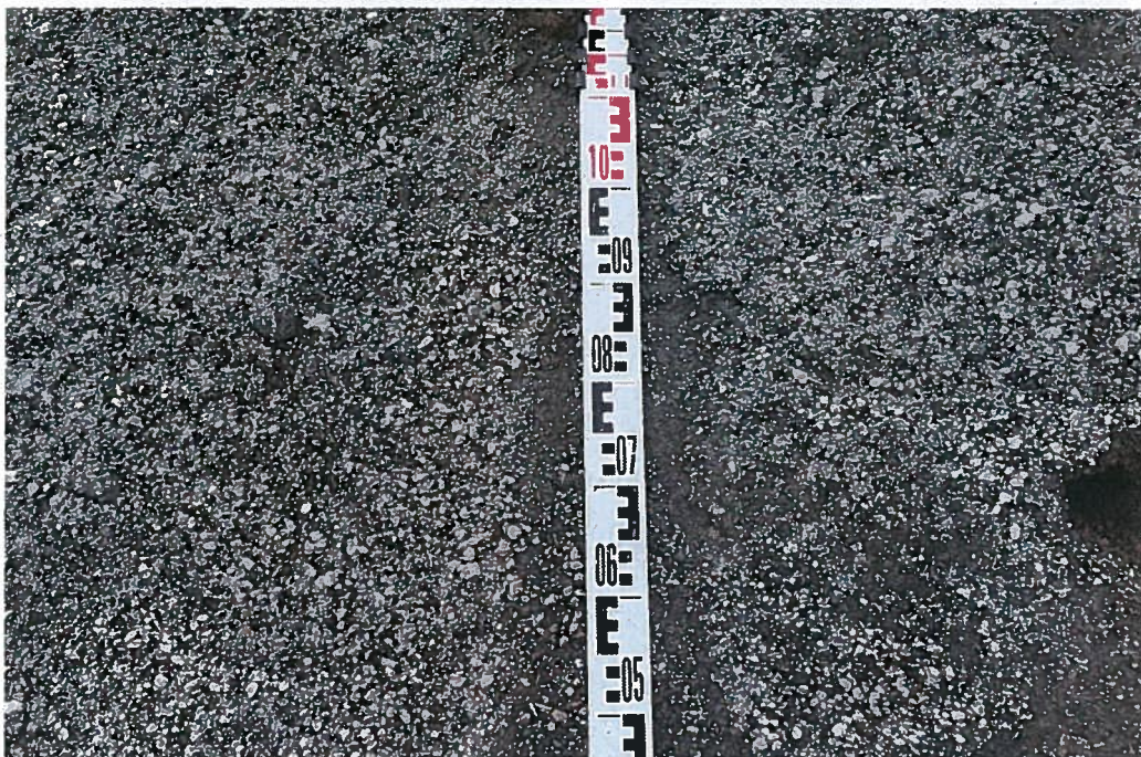
Foto 2: Detailaufnahme der recycelten Gesteinskörnung
