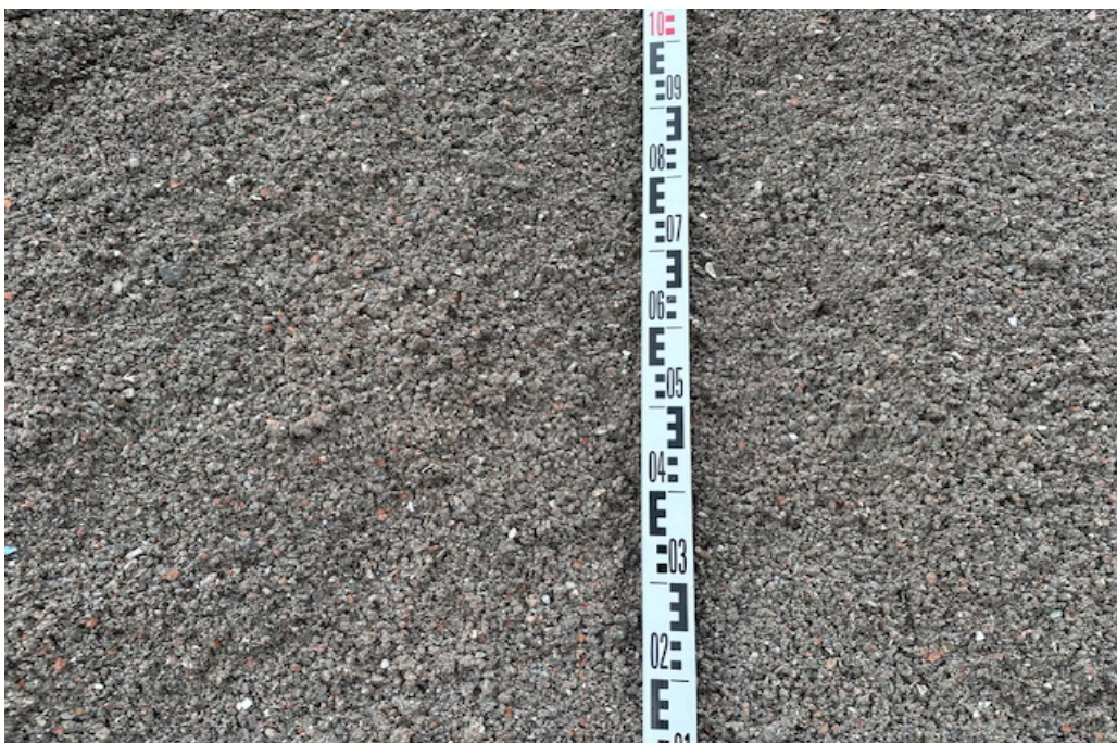
Foto 2: Detailaufnahme der recycelten Gesteinskörnung
